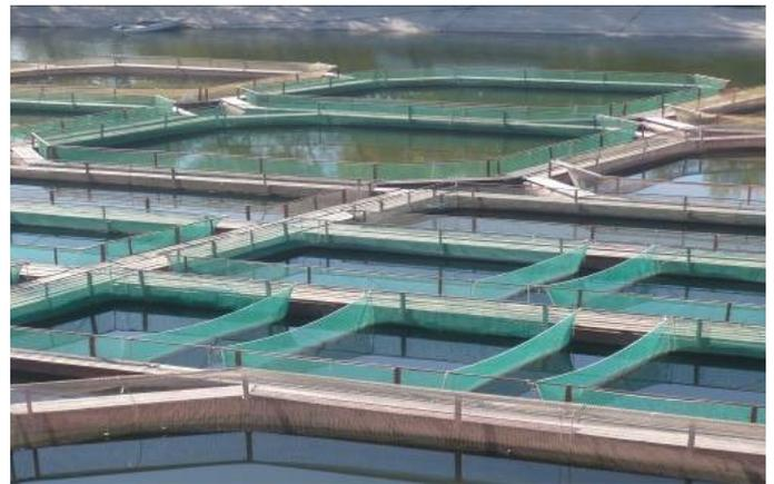
Рис. 5. Общий вид садковой линии, изготовленной из стальных труб для выращивания РМС и товарных осетровых рыб
