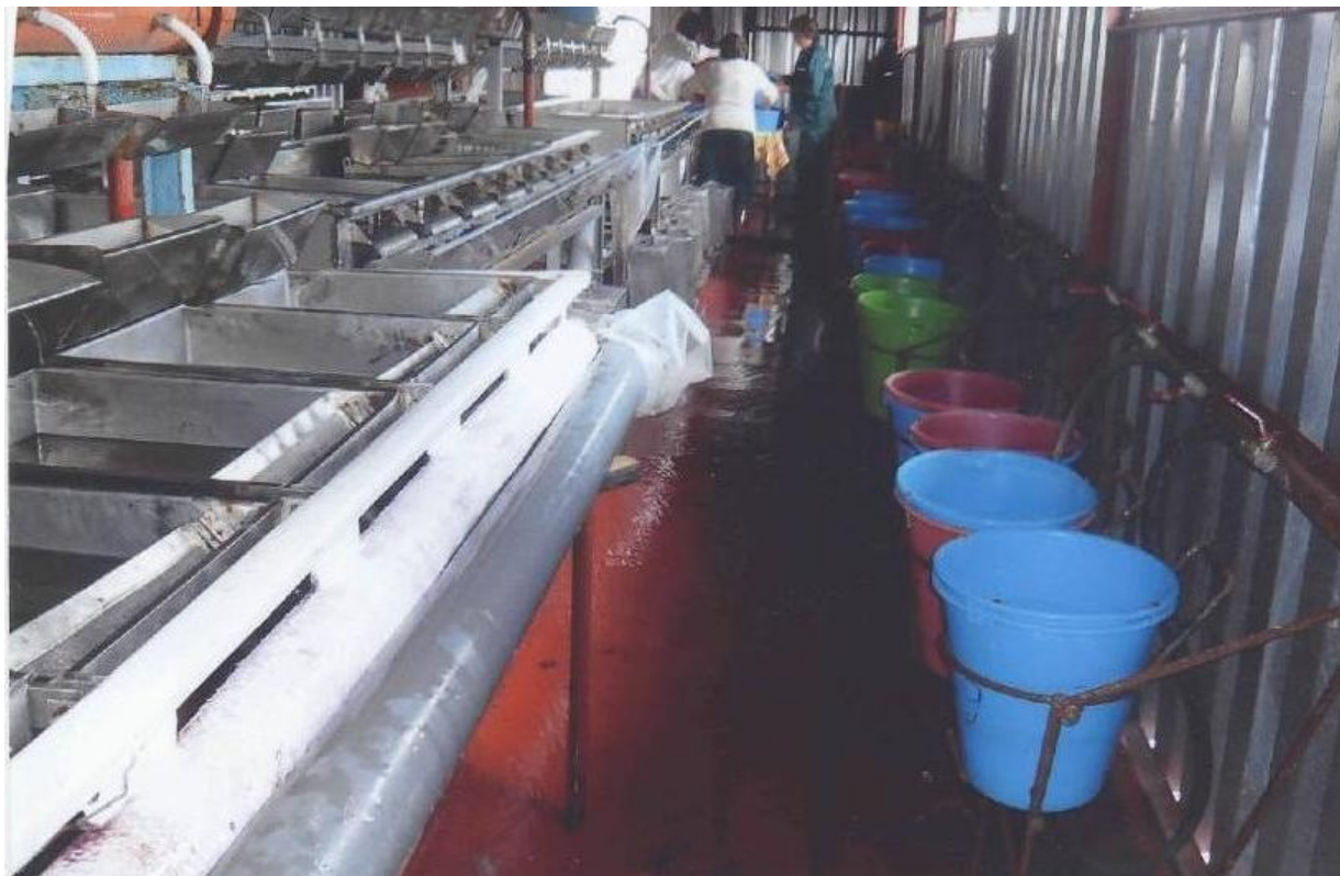
Рис. 3. Справа – аппараты для обесклеивания икры, слева – инкубационные аппараты «Осётр»
