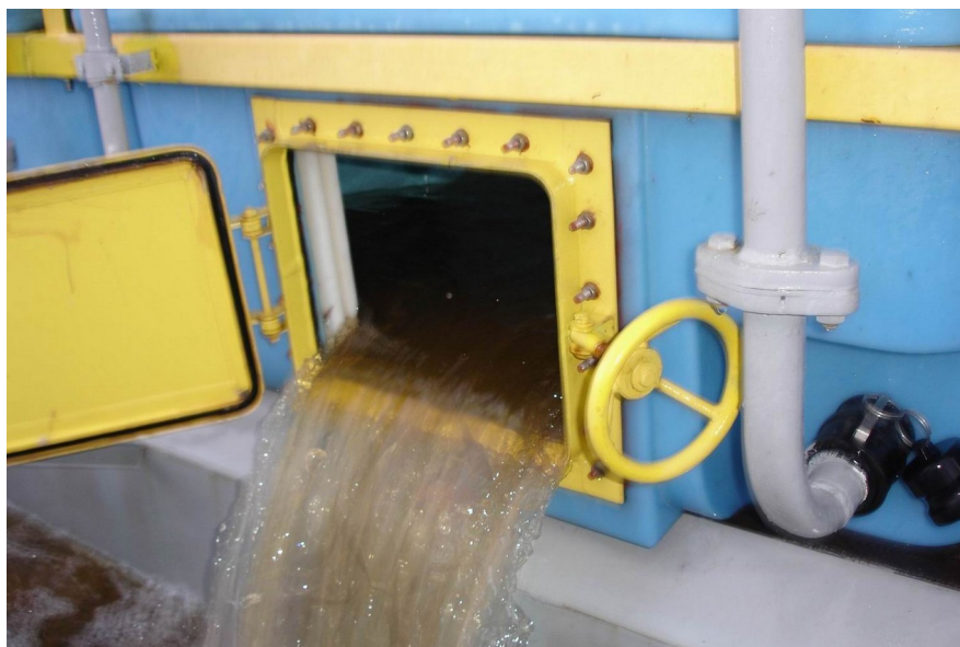
Рис. 7. Выпуск молоди осетра через нижний люк контейнера в лоток
