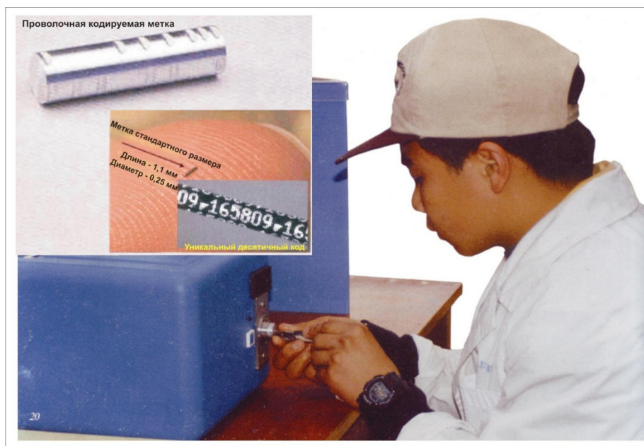
Рис. 8. Экспресс-мечение молоди китайского осетра (проволочная кодируемая микрометка с десятичным кодом)
